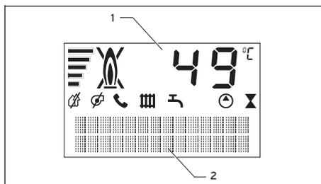
1 Индикация актуальной температуры в подающей линии системы отопления, давления наполнения системы отопления, кодов состояния или кодов ошибок
