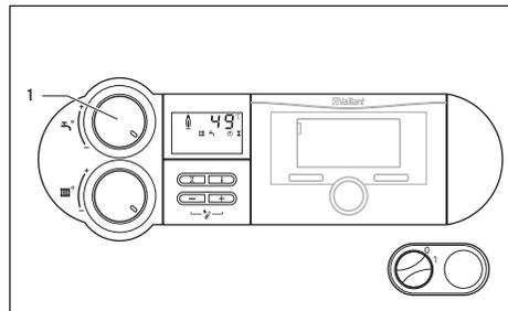
1. Поверните поворотную кнопку для регулировки температуры в накопителе (1) вправо до упора, чтобы регулятор работал исправно.
