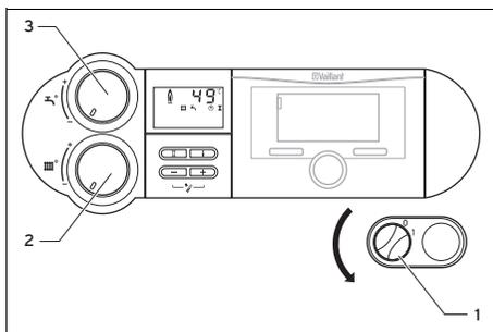
1. Поверните поворотную кнопку для регулировки температуры в накопителе (3) влево до упора.
